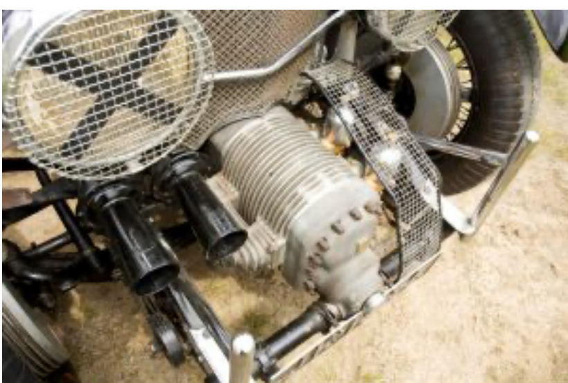
Sprężarka systemu Rootsa – Bentley „Blower”
